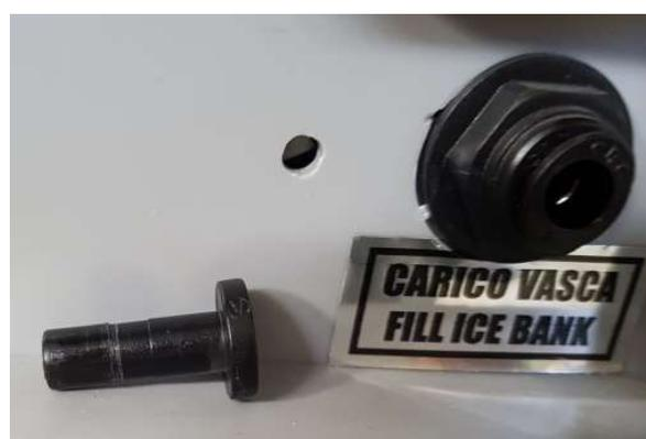
Una vez quitados los tapones, en el lateral izquierdo tenemos un indicador de máximo y mínimo de nivel de agua. Debemos cargar el banco de hielo hasta que el nivel de agua esté entre el máximo y mínimo.
