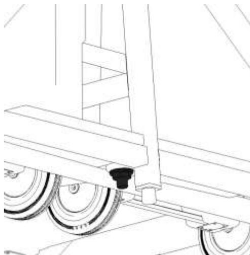
Placez sous pression la partie coudée au raccord de la partie inférieure du silo. L'autre partie doit aller vers une vidange extérieure.
