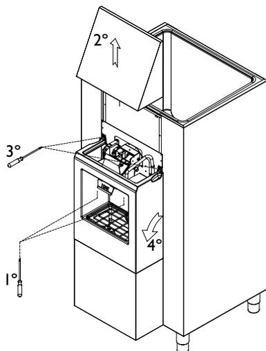
El resto del panel frontal forma un único bloque. Lo primero que se debe hacer es desenchufar los conectores eléctricos de las partes eléctricas que están a él sujetas (iluminación LED, botón de dispensación de agua...) y a continuación desenroscar los 2 tornillos que fijan esta parte. El bloque se puede desmontar inclinándolo ligeramente y extrayéndolo hacia arriba, para liberarlo de las 2 pestañas inferiores.
