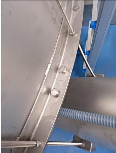
*Fori passanti realizzati per tenere dritte le viti prigioniere di fissaggio della flangia*
