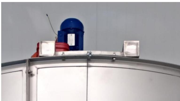
*Viti passanti per fissare il basamento dei motori alla parte superiore del silo*
