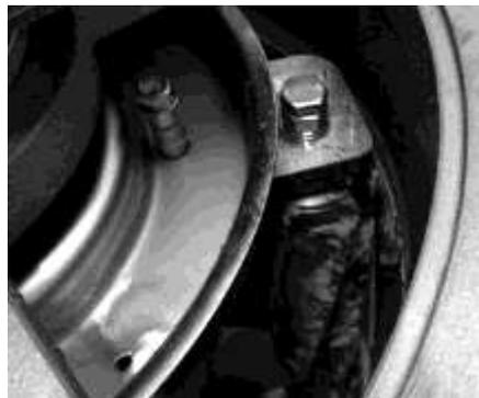
Un albero accoppiato ad un potente motoriduttore raschia il ghiaccio formatosi che cade attraverso l'apertura inferiore.
