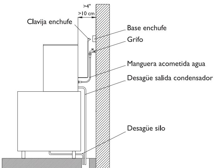
Cuando se instale una o más Modular 200 sobre cualquiera de los depósitos, se recomienda pasar los desagües de las cubetas recoge agua por dentro del depósito, tal y como se muestra en la figura.
