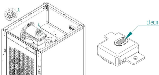
Diese Arbeiten sind bei jeder Gerätereinigung durchzuführen. Ebenfalls bei Stillstand des Gerätes aufgrund eines vollen Vorratsbehälters, sofern dies fälschlich vom Gerät erkannt wurde.
