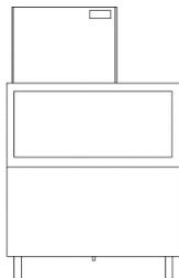
Deve essere verificata la resistenza e stabilità dell'insieme recipiente-macchina/e, oltre al fissaggio degli elementi.
