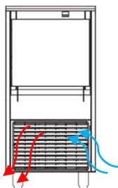
Nelle unità di R290 sottobanco, il passaggio dell'aria può avvenire nella parte frontale. L'unità permette di essere utilizzata ad incasso, con una perdita della produzione
