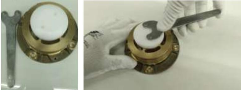
15. Colocar el kit del extrusor encima del evaporador.
