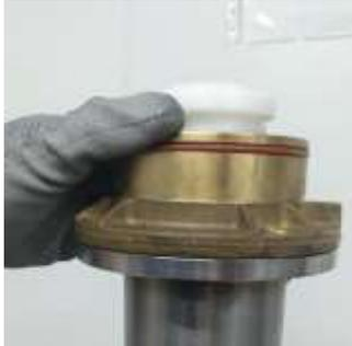
16. Atornillar el kit del extrusor al evaporador en la posición correcta para atornillar luego la cubierta de plástico de la salida de hielo.
