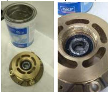
13. Colocar la junta de estanqueidad sobre el cojinete y aplicar en su superficie superior lubricante aprobado por la NSF.
