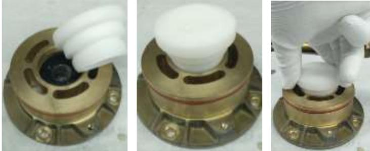
Apretar el separador de hielo con una imagen, tal como se muestra en la imagen (herramienta que se utiliza para cambiar el disco de amoladoras angulares).
