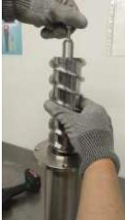
8. Girar el tornillo sin fin para colocarlo en el eje del motorreductor.
