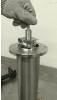
Si el tornillo sin fin queda por encima del evaporador (0,6 mm máx. (0,024 pulgadas)), está en la posición correcta.
