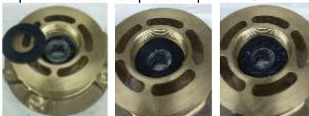
Colocar la junta tórica en la ranura exterior del extrusor y aplicar lubricante aprobado por la NSF, o su equivalente local.
