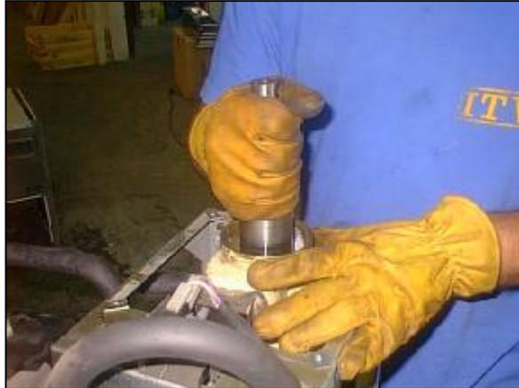
5.6. Comme indiqué sur la figure 24, il est important de ne pas oublier pendant le montage de la nouvelle vis sans fin de mettre en place la rondelle en laiton qui donnera une distance suffisante entre le moteur réducteur et le plateau de l'évaporateur.
