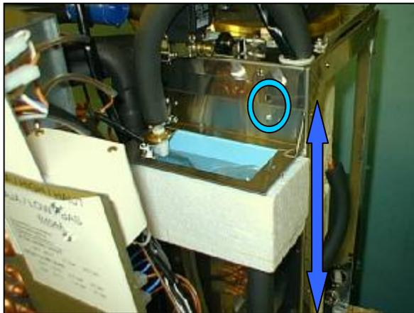
*Pour réaliser cette opération, il est recommandé de fermer le robinet d'eau puisqu'il est fort probable qu'il faille défaire une des tuyauteries raccordées au bac et, si le robinet n'est pas fermé, une importante fuite d'eau se produira, ce qui pourra mouiller un élément électrique et le détériorer.*
