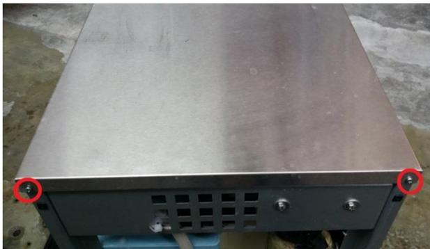
Quitar la tapa con un destornillador PH2 para acceder al motoreductor, quitando dos tornillos marcados en rojo en la foto 1.
