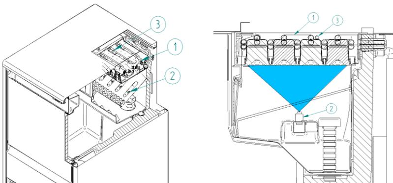
Cuando la sonda de temperatura (#3) en el extremo del evaporador alcanza un valor ajustado  $T_c$  (-12/-8°C), la fabricación continúa el tiempo fijado con la combinación de los dip-switches 1-4 (ver tabla). De esta manera podemos asegurar que el llenado del ICE CUBE es correcto en diferentes condiciones de trabajo.
