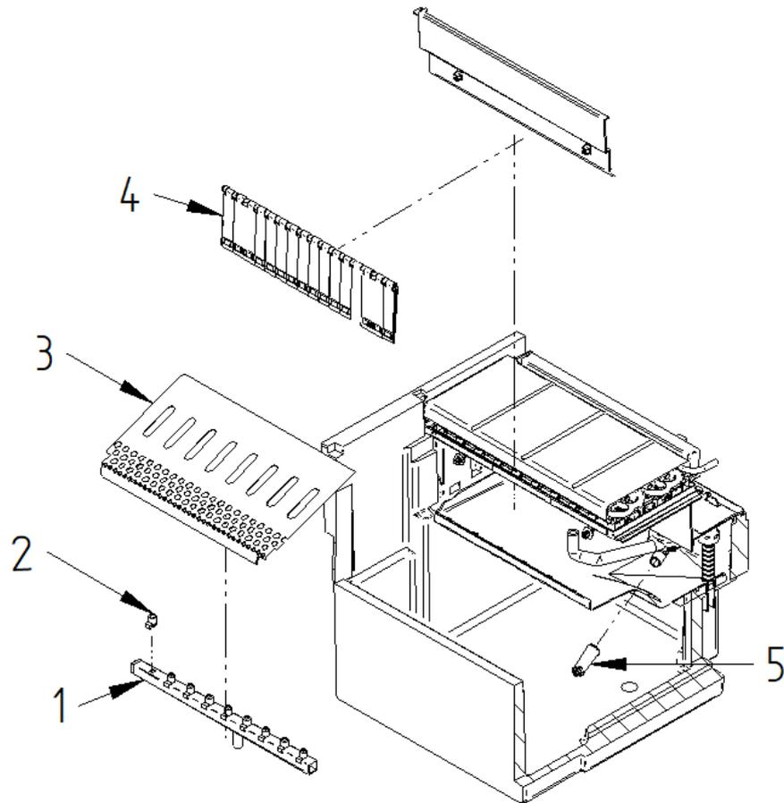
**ATENCIÓN:** ES MUY IMPORTANTE, AL SUSTITUIR EL COLECTOR QUE LOS INYECTORES ESTEN COMPLETAMENTE PERPENDICULARES AL MISMO. SI LOS CUBITOS DEL EXTREMO ESTÁN TORCIDOS, PUEDEN QUEDARSE SIN AGUA.
