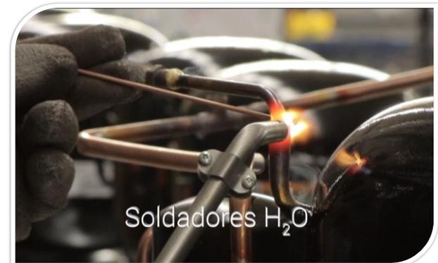
Soldadura por hidrólisis
