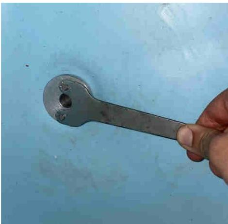
**PASSO 6:** La piastra di rinforzo va collocata nella parte inferiore esterna del serbatoio. Inserire la filettatura del coperchio sporgente nel foro della piastra di rinforzo.
