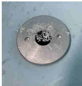
**PASSO 5:** Una volta posizionato il coperchio con la guarnizione, è necessario tenerlo in posizione con la chiave per smerigliatrice in modo che non si muova o ruoti su sé stesso.
