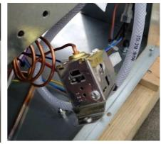
2- Lösen und reinigen Sie die Schraube und entfernen Sie den Kleber mit einem Cutter.
