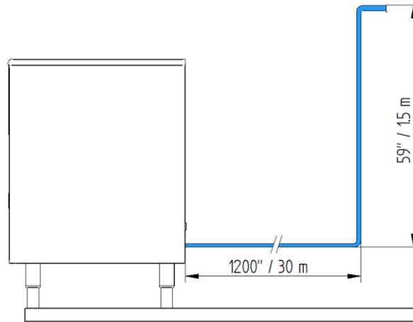
Se il tubo di scarico non funziona correttamente, la pompa potrebbe non essere in grado di scaricare l'acqua, perché il flusso della pompa potrebbe essere influenzato dalla presenza di aria immagazzinata all'interno del circuito.
