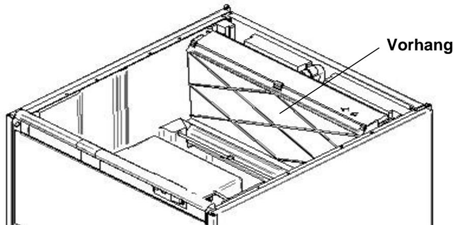
12. Alle Vorhangflächen mit dem Reinigungsprodukt und einer Bürste (keine Drahtbürste) oder Tuch, reinigen. Alle Flächen mit Wasser spülen.
