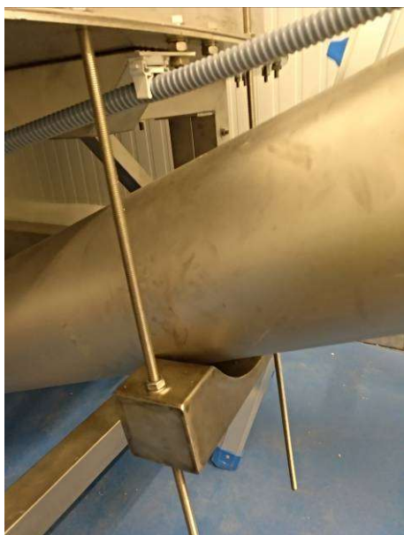
Cuna para apoyo sinfín salida. Si hace falta colocar abrazadera
