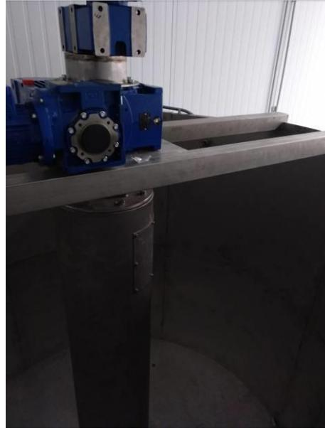
Se debe de tener en cuenta que los ejes con chaveta deben de coincidir con la de los motores, para que entren. Si hace falta moverlos para dejarlos en la posición adecuada. Y recordar poner algo de grasa en las chavetas para que entren sin problemas. Aconsejamos comprobar antes de montar que los ejes entran en los motores.
