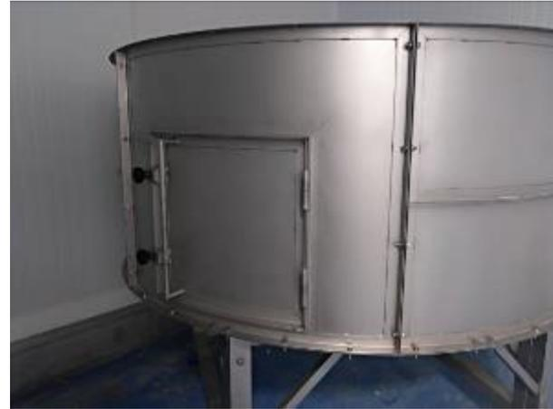
Monter ensuite les parties supérieures, avec les vis (vis avec groover et rondelle, et en-dessous rondelle et écrou). Sur les côtés, union d'une à l'autre pièce, positionner les vis dans le sens inverse.
