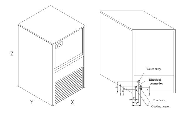
\* HEIGHT Z REPRESENTS MINIMUM MACHINE HEIGHT. IF LEGS ARE PLACED UNDER MACHINE, THEN ADD AN EXTRA 80 MM.\*
