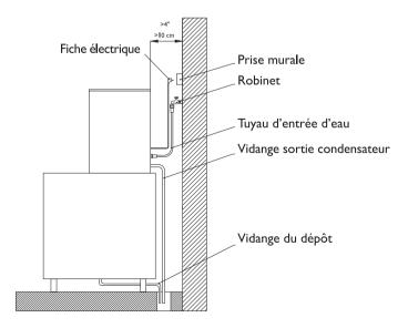
Si l'on installe un ou plusieurs machines Modular 200 sur n'importe quel dépôts à glaçons, il est recomendé de faire paser les tuyaux de vidange du bac à glaçons par l'intérieur du dépôt, comme l'on voit sur la figure.
