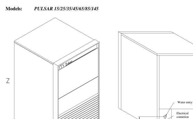
La cota Z es la minima altura de la máquina. Esta puede aumentarse hasta en 80 mm poniendo las patas supletorias
