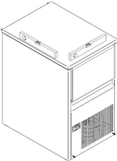
Utilizzare una livella sulla parte superiore del produttore di ghiaccio per assicurarsi che sia perfettamente a livello con il pavimento.
