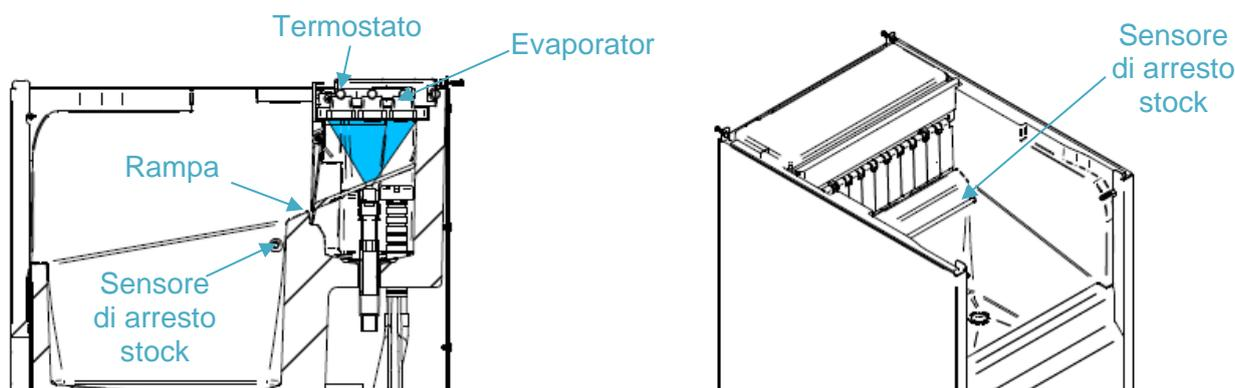
Al termine del tempo del gas caldo inizia il tempo di produzione. Quando l'evaporatore raggiunge una temperatura (Tc) di -12°C /-8°C secondo la configurazione DIP SW1-8, inizia il tempo di produzione di 10'. Variabile tra 6-36' secondo DIP SW1 (MICRO 1,2,3,4).
