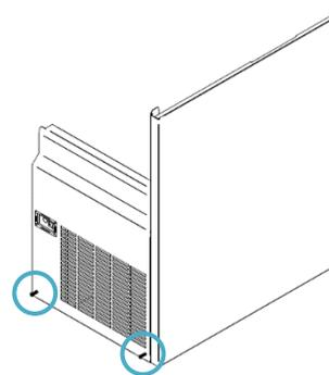
4. Pulire con l'aiuto di un aspirapolvere, una spazzola non metallica o aria a bassa pressione. Pulisci dall'alto verso il basso, non da un lato all'altro. Fare attenzione a non piegare le alette del condensatore.
