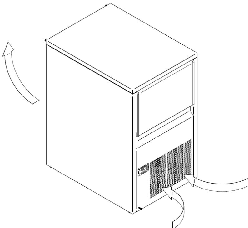
Il flusso d'aria nelle macchine compatte raffreddate ad aria entra attraverso la griglia anteriore, entra dalla parte anteriore destra ed esce dalla parte posteriore. Inoltre, l'unità è dotata di una griglia di ventilazione posteriore. Non ostruire la griglia anteriore con alcun oggetto.
