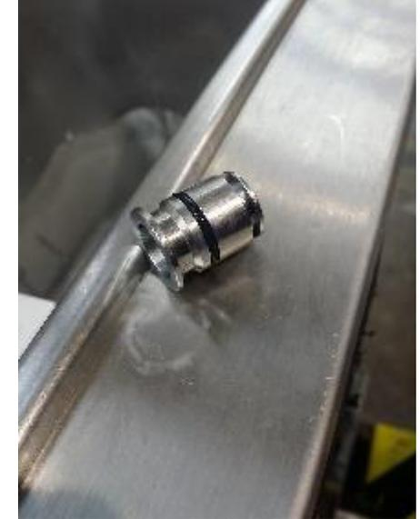
6. Desmontar regulador aire levantando el mismo. Retirar mando regulación girando en sentido contrario agujas del reloj.
