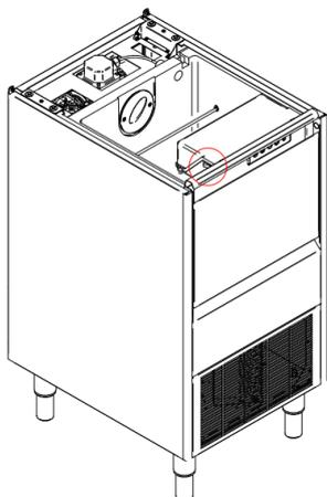
1. Abrir la entrada de agua. Verificar la no existencia de fugas.
