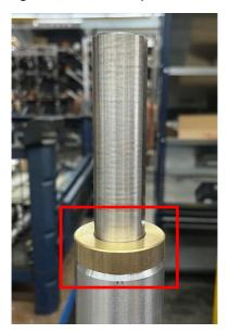
2. Setzen Sie die Buchse und den Schlüssel in die Spindel ein.
