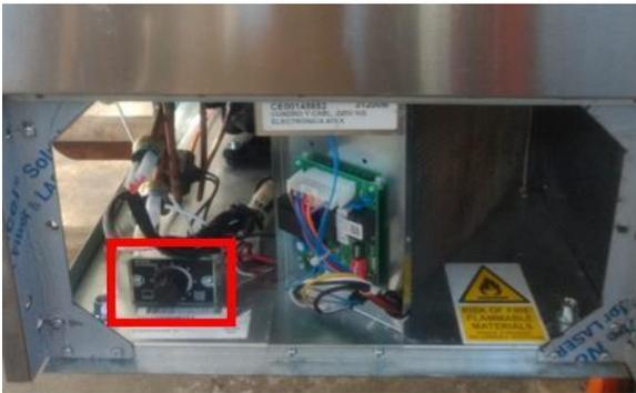
2-. Les thermostats peuvent être réglés de la position 1 (température la plus élevée : 11 °C) à la position 7 (température la plus basse : 4 °C).
