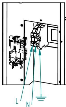
*Morsetto per collegare l'alimentazione al condensatore posizionato dietro alla piastra metallica.*
