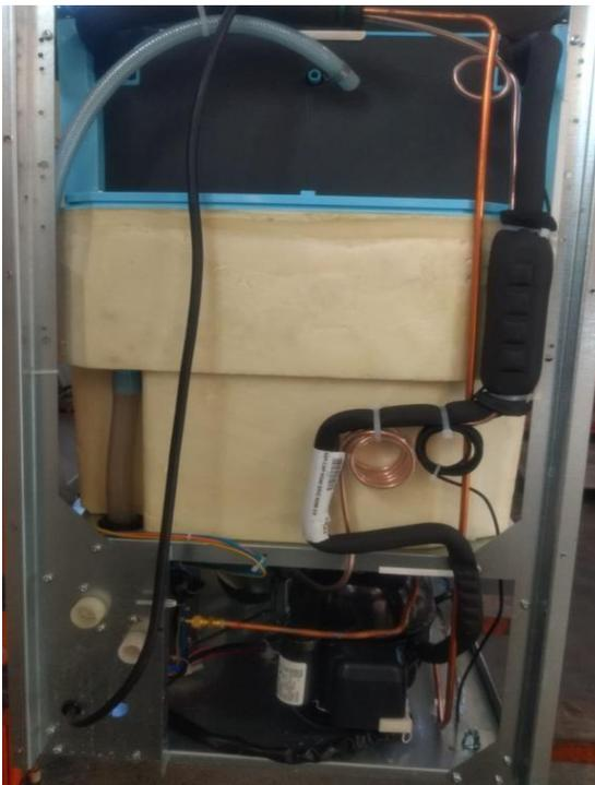
2- Installez la sonde dans le dernier tube de l'évaporateur, comme montré sur la photo.
