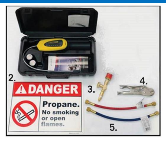
R290 SERVICE KIT 1.- COMBUSTIBLE GAS METER 2.- SAFETY PLACARD 3.- CHARGING VALVE 4.- PINCHO OFF TOOL 5.- 12" REFRIGERATION HOSE
